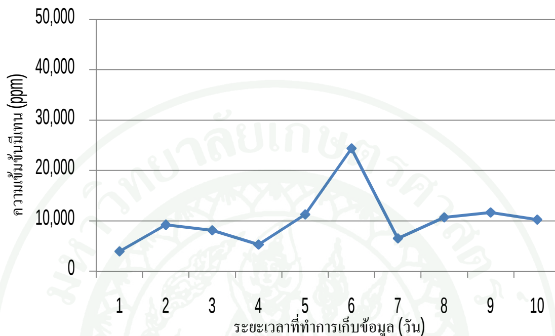
ภาพที่ 35 แผนภาพแสดงความเข้มข้นของก๊าซมีเทนเฉลี่ยตามระยะเวลา จากตะกอน จุดเก็บตัวอย่างที่ 4
