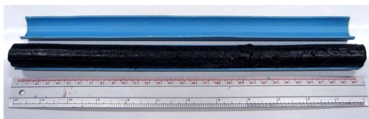
ภาพที่ 14 ลักษณะจีฟิงพาราฟินผสมกับโพแทสเซียมเปอร์แมงกาเนตขนาดเส้นผ่านศูนย์กลาง 1 เซนติเมตร ยาว 30 เซนติเมตร ขึ้นรูปในท่อพีวีซี ใช้ในการทดลองส่วนที่ 2
