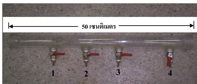
ภาพที่ 4 ลักษณะของคอลัมน์บรรจุดินทรายที่ใช้ในการทดลอง
