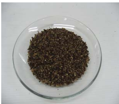
ภาพที่ 34 ลักษณะของดินทรายหลังจากการออกซิเดชันโทลูอินด้วยโพแทสเซียมเปอร์เมงกานेट
