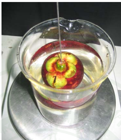
ภาพที่ 18 การชั่งน้ำหนักผลมังคุดในน้ำ ( W_d )
