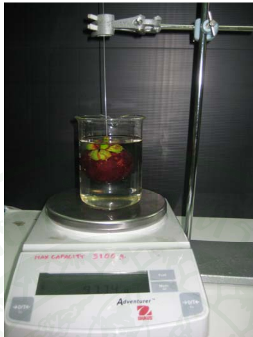
ภาพที่ 16 อุปกรณ์หาความถ่วงจำเพาะของผลมังคุด
