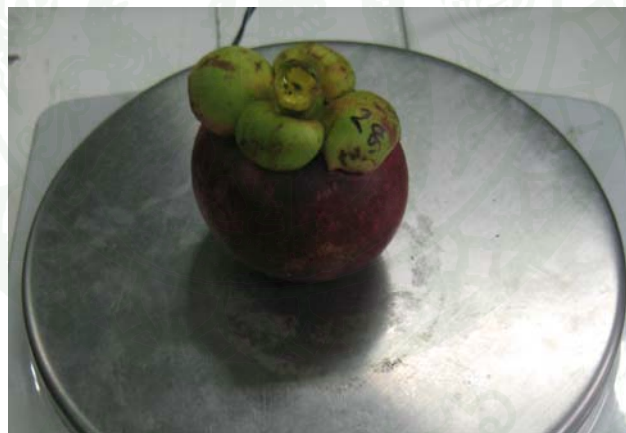
ภาพที่ 17 การชั่งน้ำหนักผลมังคุดในอากาศ ( W_p )
