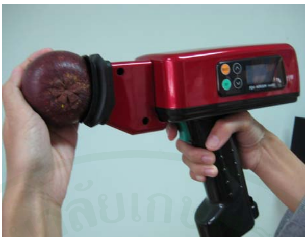
ภาพที่ 13 การวัดมังคุดบนแนวเส้นอิควาเตอร์ด้วย เครื่อง FQA-NIR GUN
