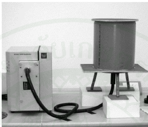
ภาพที่ 12 อุปกรณ์ NIR แบบ Interactance สำหรับการวัดคุณภาพของผลมะม่วงสุก
