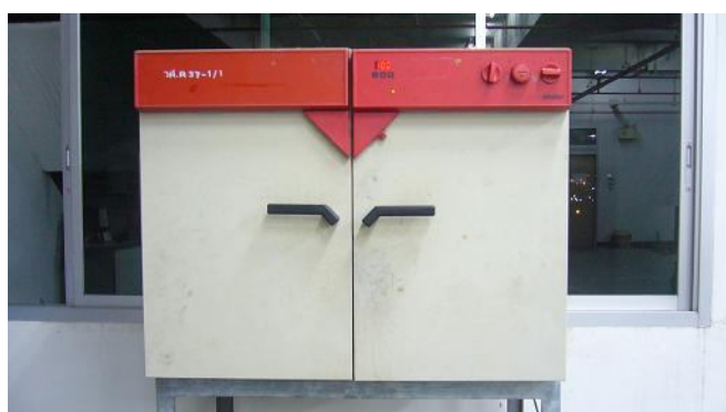
ภาพที่ 3.3 ตู้อบไฟฟ้ายี่ห้อ WTC Binder รุ่น TRE 3
