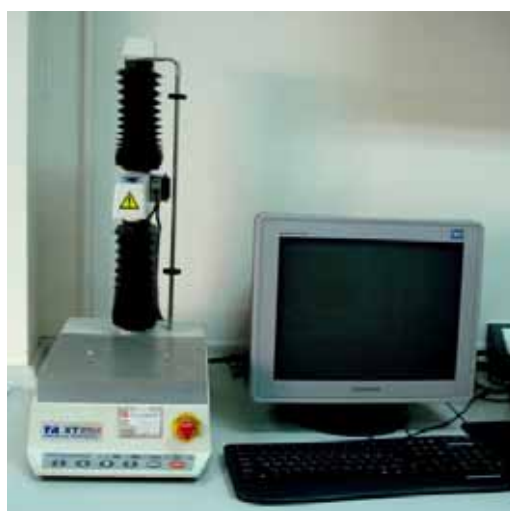
ภาพที่ 29 เครื่องวัดเนื้อสัมผัส Texture Analyser
