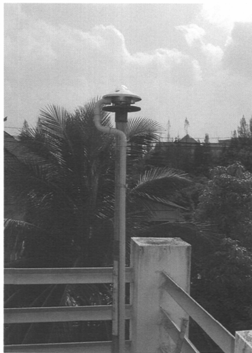
รูปที่ 3.2 อุปกรณ์วัดรังสีรวมที่ศูนย์อุตุนิยมวิทยาภาคเหนือ จังหวัดเชียงใหม่
