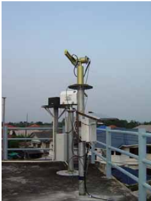
รูปที่ 3.27 เครื่อง sunphotometer ของสถานีอุบลราชธานี
