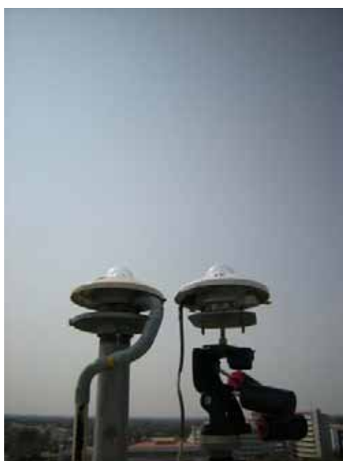
รูปที่ 3.19 การสอบเทียบไพราโนมิเตอร์ที่สถานีนครปฐม เมื่อเดือนกุมภาพันธ์ 2010
