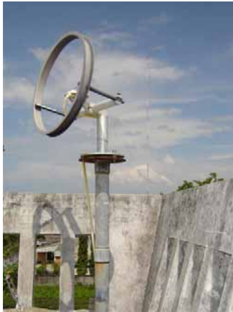
รูปที่ 3.15 อุปกรณ์วัดรังสีกระจายที่ศูนย์อุตุนิยมวิทยาภาคใต้ฝั่งตะวันออก จังหวัดสงขลา
