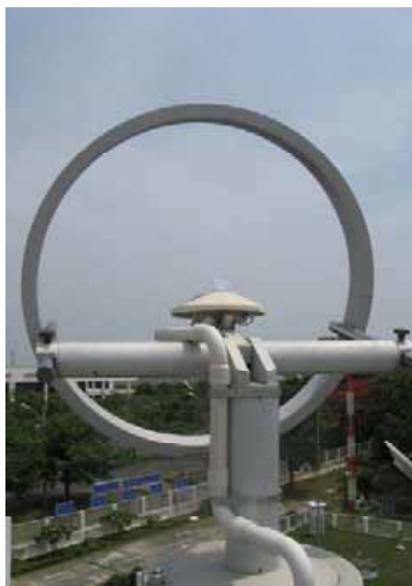
รูปที่ 3.7 อุปกรณ์วัดรังสีกระจายที่ศูนย์อุตุนิยมหาวิทยาลัยภาคตะวันออกเฉียงเหนือ จังหวัดอุบลราชธานี
