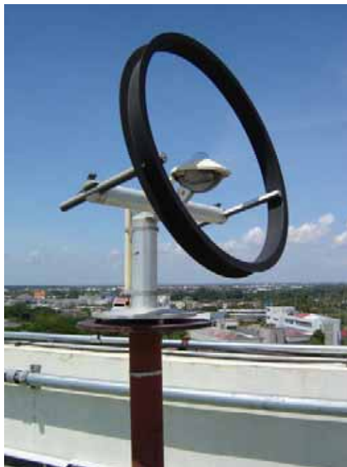
รูปที่ 3.11 อุปกรณ์วัดรังสีกระจายที่มหาวิทยาลัยศิลปากร จังหวัดนครปฐม
