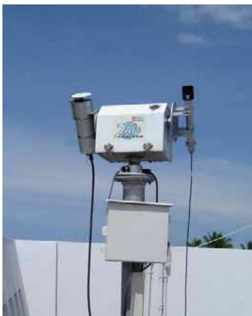
รูปที่ 3.14 อุปกรณ์วัดรังสีตรงที่ศูนย์อุตุนิยมวิทยาภาคใต้ฝั่งตะวันออก จังหวัดสงขลา
