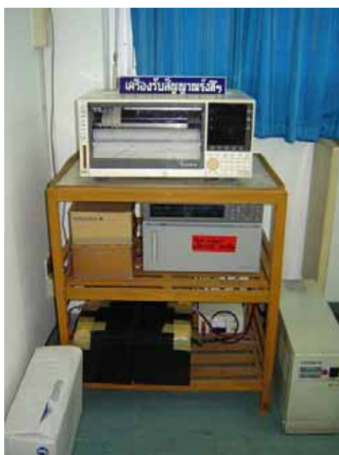
รูปที่ 3.8 อุปกรณ์บันทึกข้อมูลที่ศูนย์อุตุนิยมหาวิทยาลัยภาคตะวันออกเฉียงเหนือ จังหวัดอุบลราชธานี
