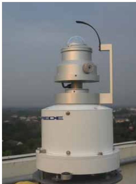
รูปที่ 3.32 เครื่องถ่ายภาพท้องฟ้าของสถานีนครปฐม
