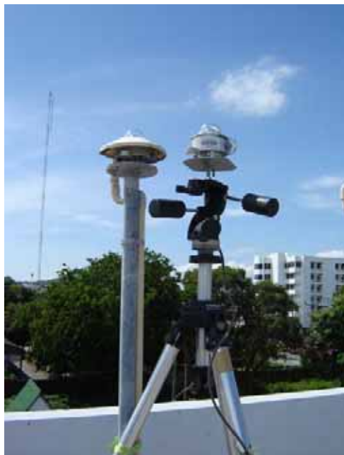
รูปที่ 3.20 การสอบเทียบไพราโนมิเตอร์ที่สถานีสงขลา เมื่อเดือนเมษายน 2009
