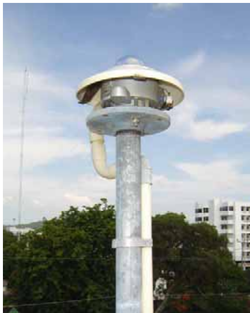
รูปที่ 3.13 อุปกรณ์วัดรังสีรวมที่ศูนย์อุตุนิยมวิทยาภาคใต้ฝั่งตะวันออก จังหวัดสงขลา
