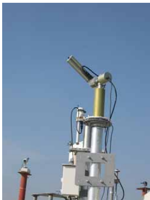
รูปที่ 3.28 เครื่อง sunphotometer ของสถานีนครปฐม
