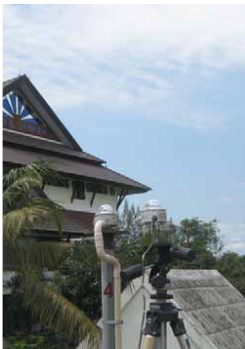
รูปที่ 3.17 การสอบเทียบไพราโนมิเตอร์ที่สถานีเชียงใหม่ เมื่อเดือนพฤษภาคม 2009
