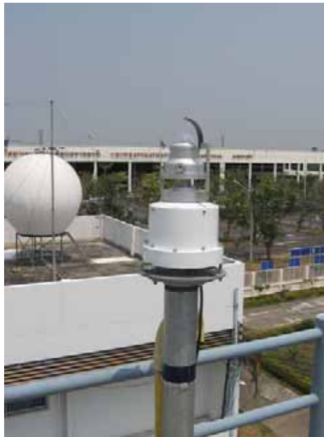
รูปที่ 3.31 เครื่องถ่ายภาพท้องฟ้าของสถานีอุบลราชธานี
