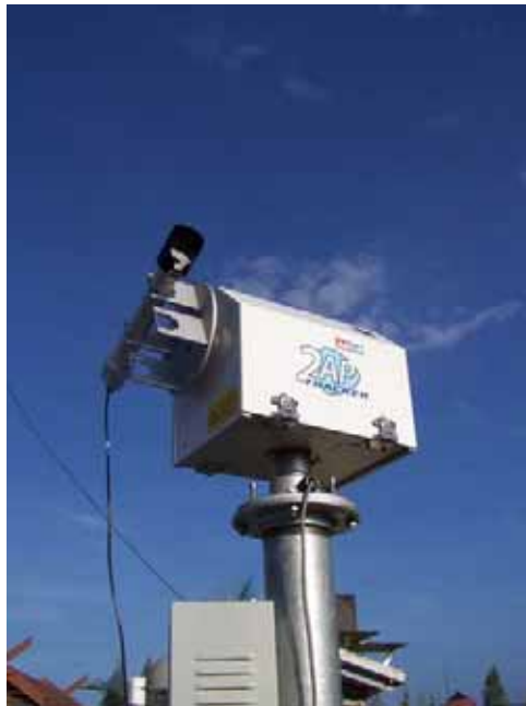
รูปที่ 3.3 อุปกรณ์วัดรังสีตรงที่ศูนย์อุตุนิยมวิทยาภาคเหนือ จังหวัดเชียงใหม่
