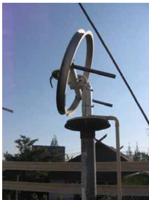
รูปที่ 3.4 อุปกรณ์วัดรังสีกระจายที่ศูนย์อุตุนิยมวิทยาภาคเหนือ จังหวัดเชียงใหม่
