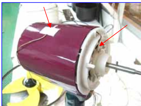
ภาพที่ 3 แสดงจุดที่ทำการวัดค่าอุณหภูมิด้วยเครื่องเทอร์โมคัปเปิลที่ ขดลวด(coil),แผ่นเหล็กที่ยึดขดลวด(stator), โครงโลหะยึดมอเตอร์พัดลมหน้า-หลังจำนวน 2 จุด (front-rear frame ) ฝาครอบมอเตอร์หน้า-หลัง รวมจำนวน 2 จุด (front-rear cover )
