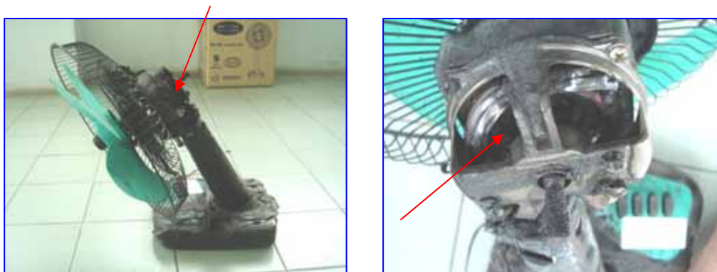
ภาพที่ 29 แสดงสภาพเครื่องใช้พัดลมไฟฟ้ายี่ห้อ A จากการศึกษารายงานสภาพอะไหล่ที่เกิดการลัดวงจรมอเตอร์ ซึ่งได้รับความเสียหายเกิดเพลิงไหม้ต่อเนื่องแต่ได้ทำการใช้เครื่องดับเพลิงทำการดับก่อน ซึ่งพบการลุกลามไหม้ที่พลาสติกหล่อที่แกนโรเตอร์ทางด้านหลัง
