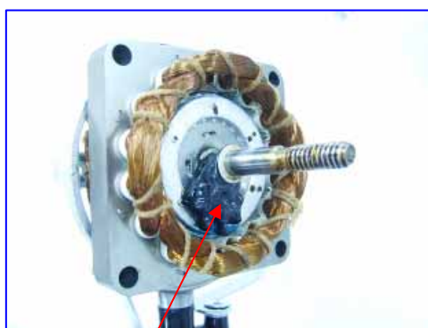
ภาพที่ 15 แสดงการหลอมละลายของพลาสติกค่อล่าที่แกนโรเตอร์ ของเครื่องใช้พัดลมไฟฟ้า ยี่ห้อ C จากการใช้งานสภาวะผิดปกติเกิดการล๊อคแกนโรเตอร์ ประกอบกับได้รับ แรงดันไฟฟ้าเป็น 242 V เปิดใช้งานเป็นระยะเวลา รวม 8 ชั่วโมง
