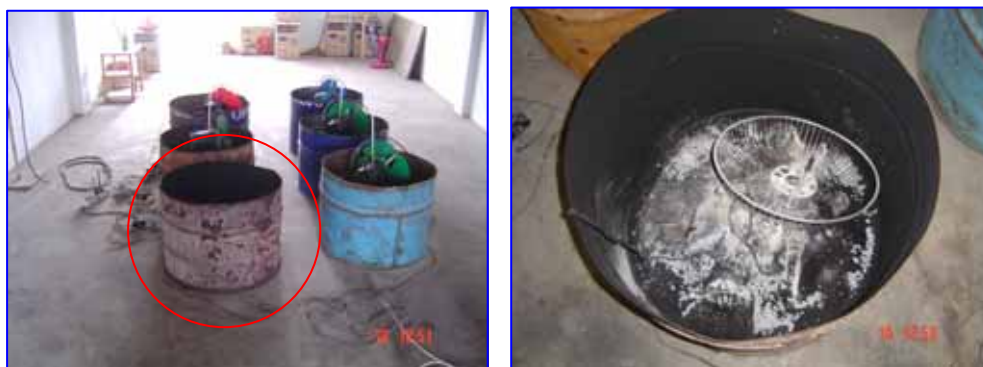
ภาพที่ 28 แสดงสภาพเครื่องใช้พัดลมไฟฟ้ายี่ห้อ A จากการศึกษาใช้งานสภาวะผิดปกติเกิดการล๊อคแกนโรเตอร์ซึ่งได้รับความเสียหายเกิดเพลิงไหม้ต่อเนื่อง
