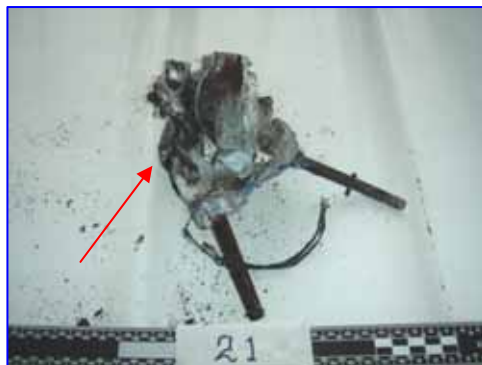
ภาพที่ 30 แสดงสภาพเครื่องใช้พัฒนไฟฟ้ายี่ห้อ A จากการศึกษาใช้งานสภาวะผิดปกติเกิดการ ล็อกแกนโรเตอร์ ซึ่งได้รับความเสียหายเกิดเพลิงไหม้ต่อเนื่อง ซึ่งพบโครงโลหะยึด มอเตอร์พัฒนามีสภาพบอบช้ำ
