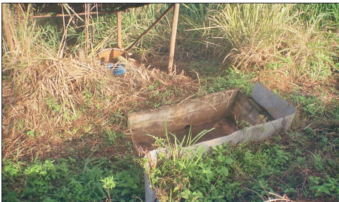
ภาพที่ 12 ลักษณะบ่อดักตะกอนดินและน้ำบริเวณท้ายแปลงเกษตรกรรมที่ใช้มาตรการอนุรักษ์ดินและน้ำต่างๆ สำหรับเก็บตัวอย่างตะกอนดิน และตัวอย่างน้ำ
