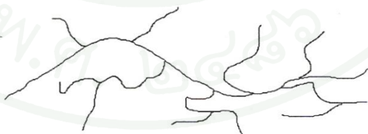
ภาพที่ 3 โครงสร้างของพอลิเอทิลีนความหนาแน่นต่ำ
