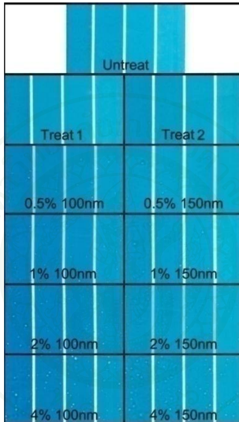
ภาพที่ 31 ลักษณะของสี Cyan บนงานพิมพ์ของฟิล์มพอลิเอทิลีนความหนาแน่นต่ำที่ภาวะต่างๆ
