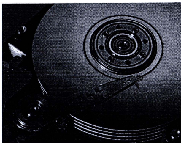
ภาพที่ 2.4 รูปร่างลักษณะของแขนของแผ่นจานแม่เหล็ก [4]
