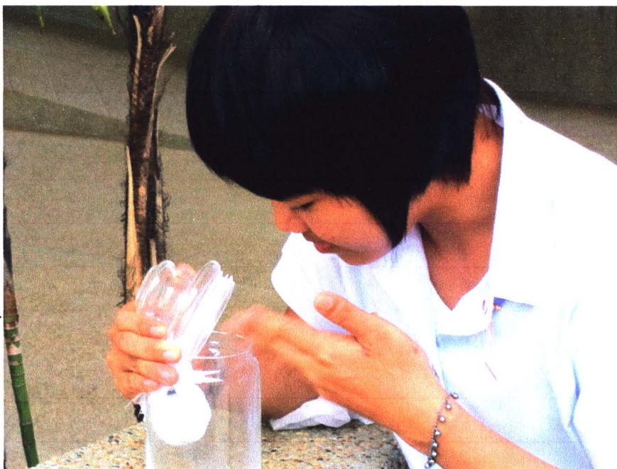
ภาพที่ 26 การประเมินผลของผู้ทดสอบกลิ่น โดยการดมกลิ่นน้ำเสียที่ผ่านการดูดซับจากตัวกรองชีวภาพแต่ละประเภท
