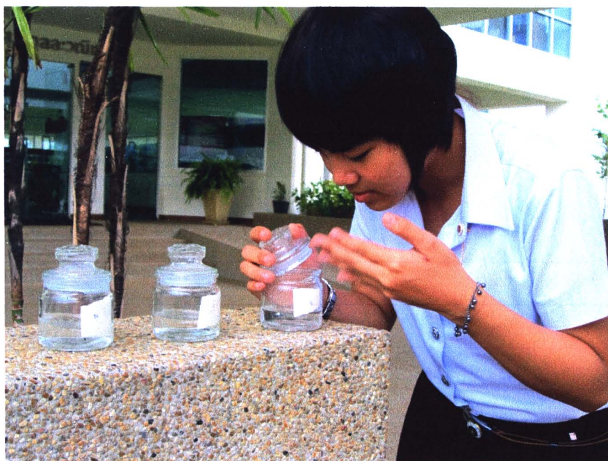
ภาพที่ 25 การทดสอบการดมกลิ่นสาร 1-Butanol เพื่อคัดเลือกผู้ทดสอบกลิ่น
