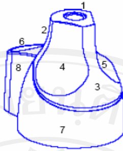
รูป 3.3 ตำแหน่งในการนับรอยตำหนิของชิ้นส่วนไดนาโมจักรยาน ลักษณะรอยตำหนิแบ่งออกเป็น 4 ประเภทดังต่อไปนี้
