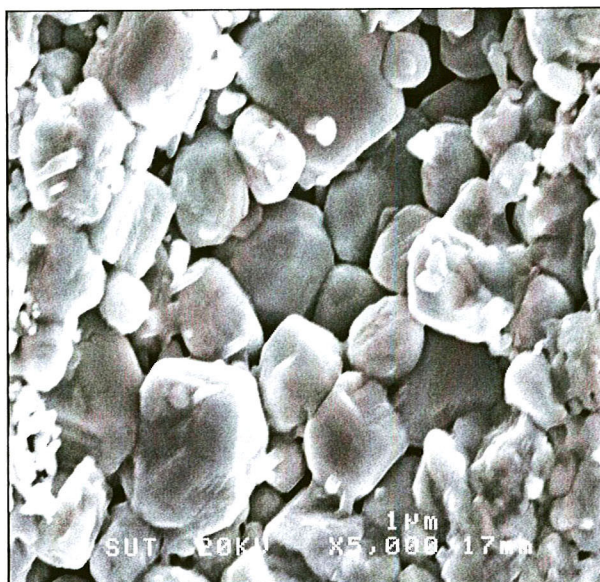
รูปที่ 50 ภาพถ่ายโครงสร้างจุลภาคของ PTCR ที่ใช้ในเชิงการค้าหมายเลข C17
