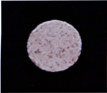
รูปที่ 57 ยาเม็ด sericin B คำรับC4 มีสภาพบิ่นบริเวณขอบ (chipping)
