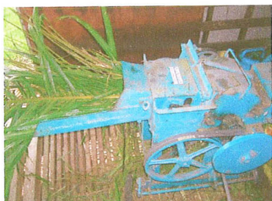
ภาพที่ 1 การสับทางไบโพลัมน์น้ำมันด้วย เครื่องสับหญ้า
