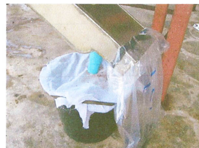
ภาพที่ 16 ภาชนะรองรับมูลและปัสสาวะ ได้กรงทดลองหาการย่อยได้
