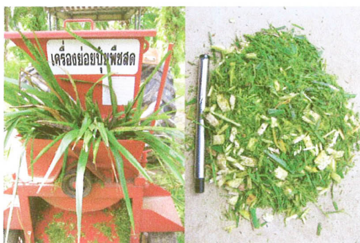
ภาพที่ 3 การสับทางใบปาล์มน้ำมันด้วยเครื่องย่อยปุ๋ยพืชสด (ก) และลักษณะชิ้นส่วนของทางใบปาล์มน้ำมันที่ผ่านการสับเพื่อใช้ในการศึกษาครั้งนี้ (ข)
