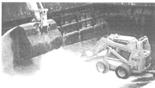
ภาพที่ 4.23 การใช้รถตักขนาดเล็กเกลี่ยสินค้าในท้องระวางเรือ
