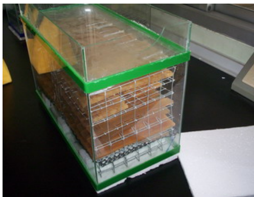
รูปที่ 3.3 การเก็บชิ้นงานไว้ในตู้ควบคุมความชื้นที่ระดับความชื้นสัมพัทธ์ 53 %
