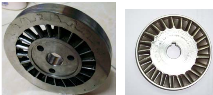
รูปที่ 4.19 แสดงใบพัดนิ่งและใบพัดหมุนเมื่อประกอบเข้ากับจานและ shroud เสร็จเรียบร้อย
