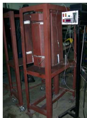
รูปที่ 4.3 แสดงห้องเผาไหม้ที่ทำการสร้างสำเร็จพร้อมหุ้มฉนวนกันความร้อนอย่างสมบูรณ์
