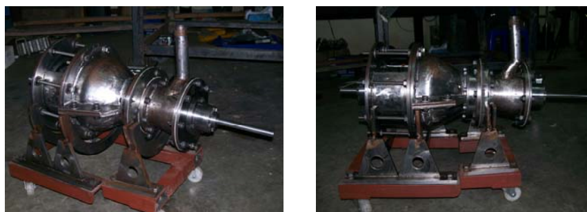
รูปที่ 4.21 แสดงก๊าซเทอร์โบที่ประกอบสมบูรณ์แล้วพร้อมเชื่อมต่อกับห้องเผาไหม้และเครื่องอัดอากาศ
