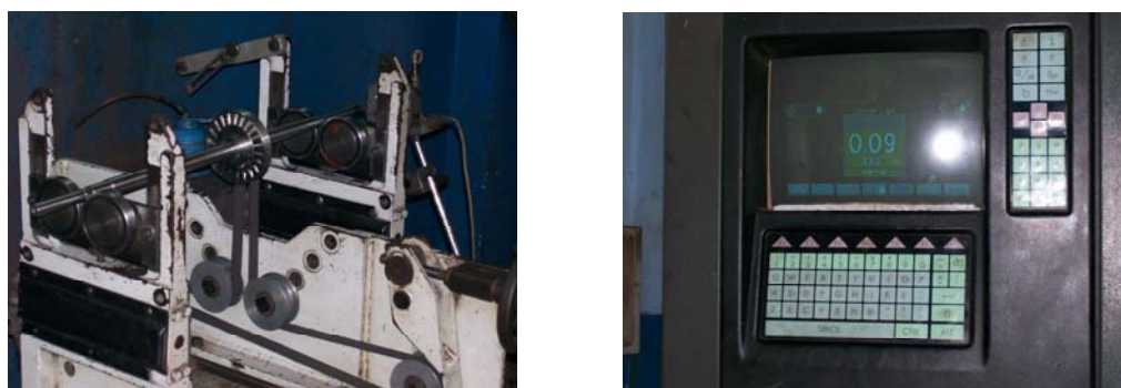
รูปที่ 4.20 แสดงการทำการปรับสมดุลการหมุนของวงล้อและเพลาขับเทอร์ไบน์ที่สร้าง ด้วยเครื่องปรับสมดุล (model zc50, version TC-GV)
