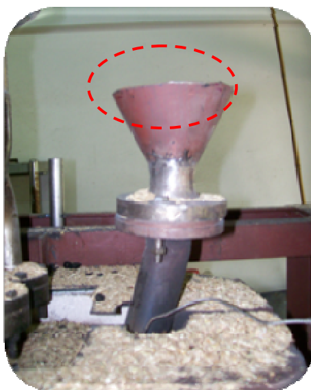
รูปที่ 5.5 แสดงบริเวณช่องป้อนเชื้อเพลิงที่เกิดความดันของอากาศในห้องเผาไหม้เมื่ออุณหภูมิสูง
