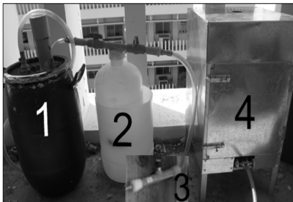
รูปที่ 4 แสดงถังหมักก๊าซชีวภาพขนาด 30 ลิตร แบบกึ่งต่อเนื่อง
