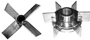
รูปที่ 2 ใบพัดกวนที่ใช้ในการทดลอง แบบกัณฑ์ 4 ใบเอียง 45 องศา (ซ้าย) และกัณฑ์ 6 ใบแบบติดบนจาน (ขวา)
