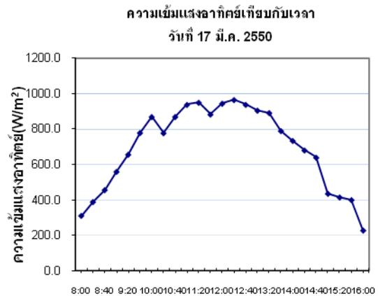
รูปที่ 6 กราฟระหว่างความเข้มแสงอาทิตย์กับเวลา
