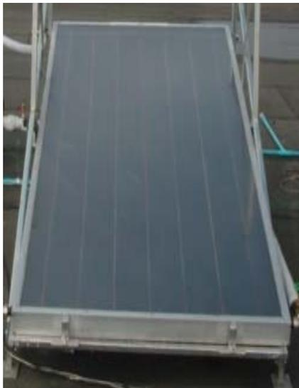
รูปที่ 1 แผงรับแสงอาทิตย์แบบแผ่นเรียบ
