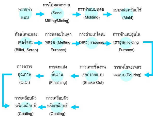
รูปที่ 1 กระบวนการผลิตเหล็กหล่อ
