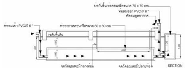
รูปที่ 9 ผังและรูปตัดขยายท่ออากาศฝังดิน
