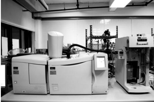
ภาพที่ 2 Thermogravimetric analyzer coupled with mass spectrometer (TG-MS)
