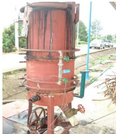
รูปที่ 3 เตาแก๊สซีฟิเคชั่นแบบเบดนิ่ง
