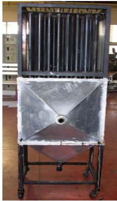
รูปที่ 4 เครื่องแลกเปลี่ยนความร้อนแบบเทอร์โมไซฟอน (Thermosyphon heat exchanger)
