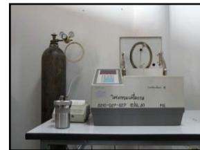
รูปที่ 2 เครื่อง Bomb Calorimeter
