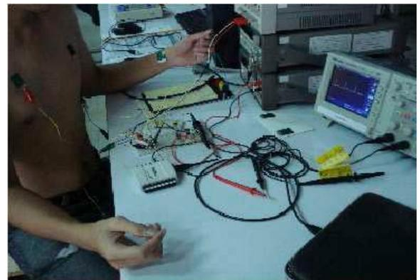
รูปที่ 5 ตัวอย่างการทดลองเครื่องวัดสัญญาณคลื่นไฟฟ้าหัวใจที่สร้างขึ้น
