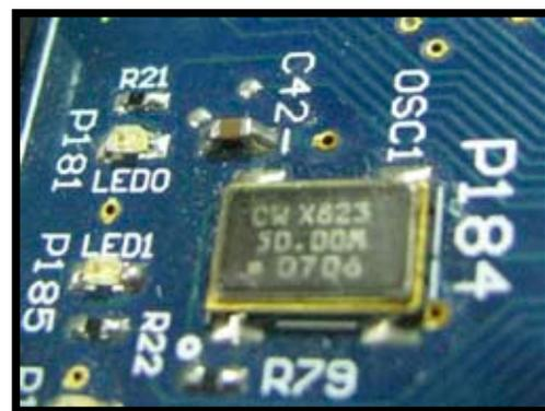
FIGURE 4. OSCILLATOR WITH 50 MHz FREQUENCY GENERATION BOARD XILINX SPARTAN 3E XC3S250E-4PQ208.
