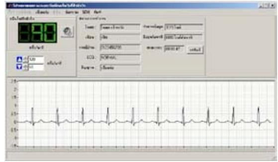
ภาพที่ 10 สัญญาณจากเครื่องจำลองคลื่นไฟฟ้าหัวใจ อัตราการเต้นของหัวใจ 90 ครั้งต่อนาที
