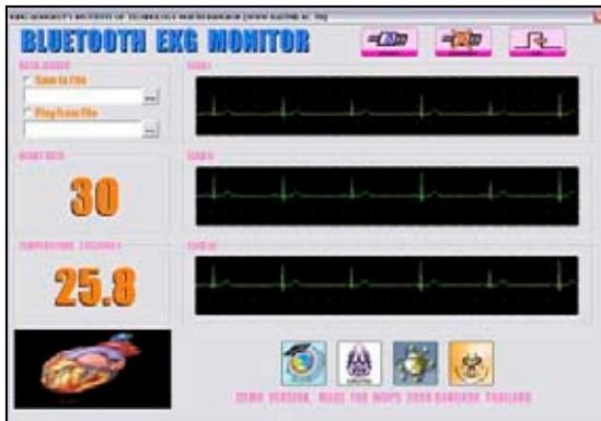
รูปที่ 6 สัญญาณจากเครื่องจำลองคลื่นสัญญาณไฟฟ้าหัวใจ ในอัตราการเต้นของหัวใจ 30 ครั้งต่อนาที
