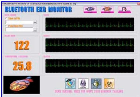
รูปที่ 8 สัญญาณจากเครื่องจำลองคลื่นสัญญาณไฟฟ้าหัวใจ ในอัตราการเต้นของหัวใจ 120 ครั้งต่อนาที
