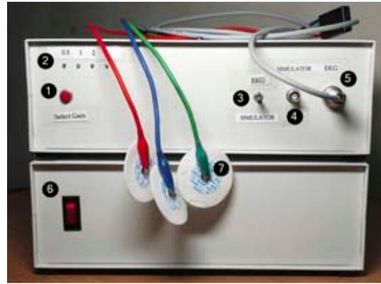
ภาพที่ 5 ด้านหน้าของเครื่องวัดคลื่นไฟฟ้าหัวใจผ่านระบบเครือข่ายคอมพิวเตอร์ TCP/IP
