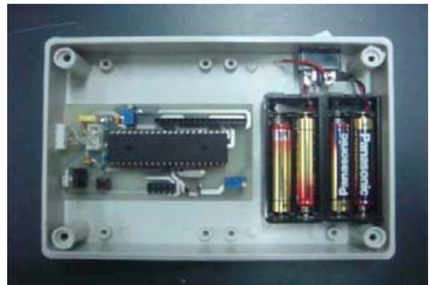
ภาพที่ 7 วงจร AVR ATmega32 และ แบตเตอรี่กล่อง
