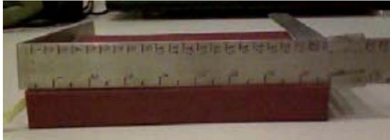
รูปที่ 2 เครื่องมือวัดความหนาตัวผู้ป่วยแบบ Scale
