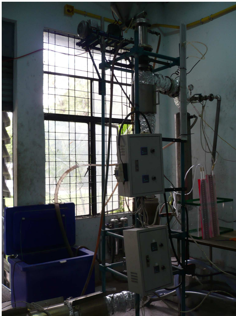
ภาพผนวกที่ 2 รูปเครื่องมือที่ใช้แตกโมเลกุลพอลิพรอพิลีน
