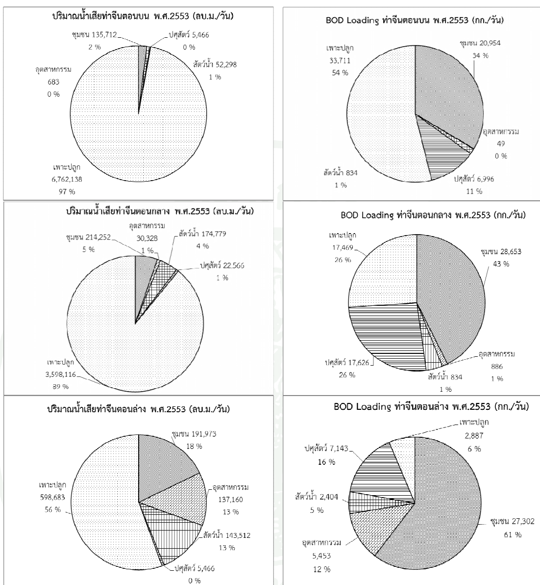
ภาพที่ 5 ปริมาณน้ำเสียและการะบรทุกของเสียในรูปปีไอคิของแม่น้ำทำจิ้น ปี พ.ศ. 2553 ตอนบน (ก) ตอนกลาง (ข) และตอนล่าง (ค)
