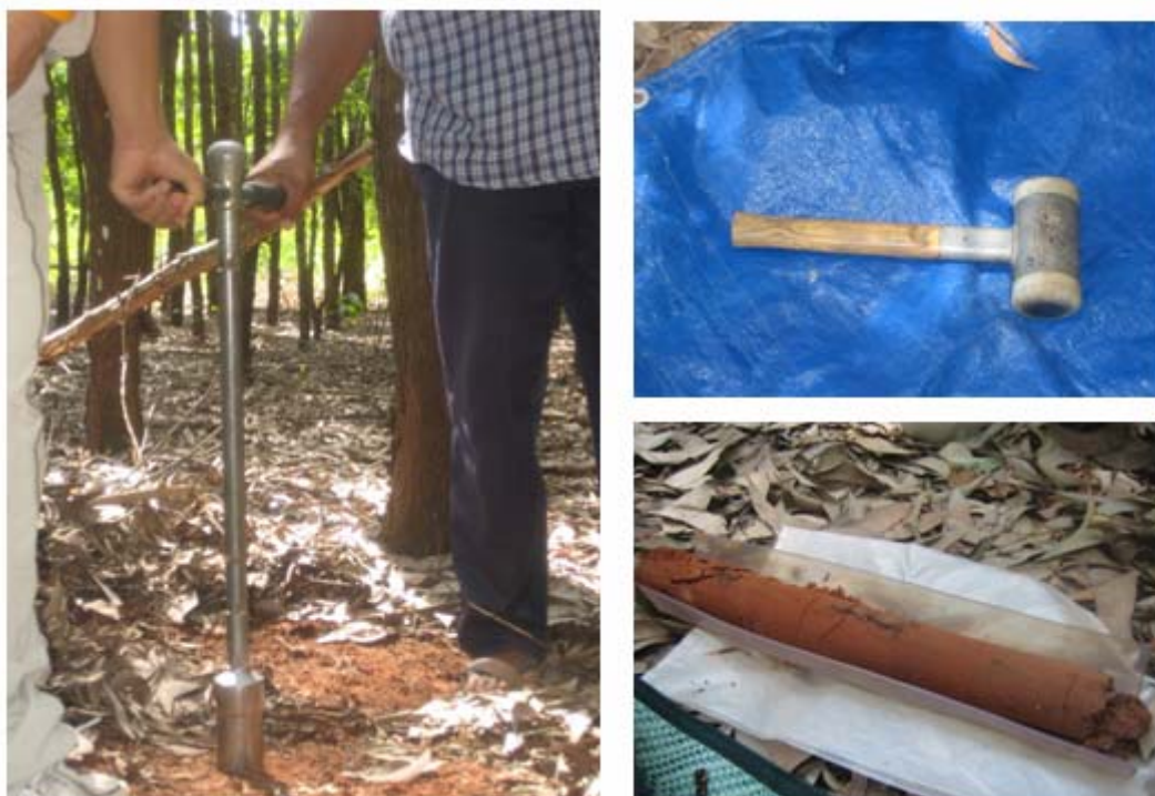
ภาพที่ 1 การเก็บตัวอย่างรากขนาดเล็ก โดยใช้อุปกรณ์เก็บตัวอย่างดิน (soil sampler)
