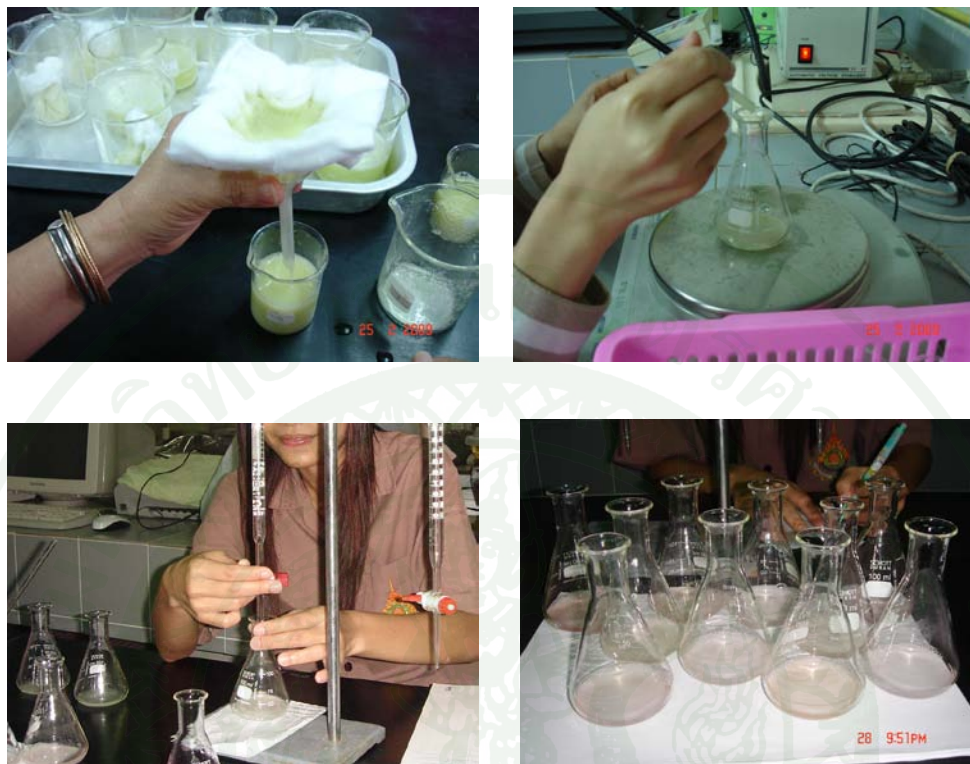
ภาพที่ 8 การตรวจวัดค่า TA โดยวิธีการไทเตรตน้ำคั้นจากผลมะม่วง ด้วย 0.1 N NaOH
