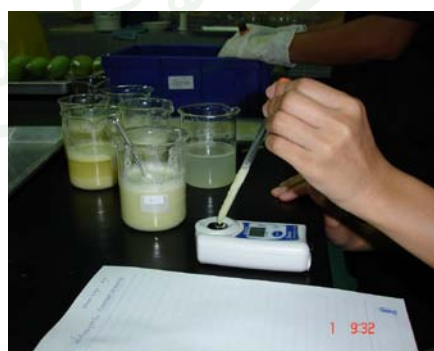
ภาพที่ 7 การวัดหาค่าปริมาณของแข็งที่ละลายได้ TSS ด้วยเครื่อง Refractometer
