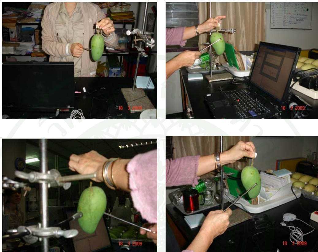
ภาพที่ 4 การวัดหาความถี่สั่นพ้องโดยการเคาะผลมะม่วง
