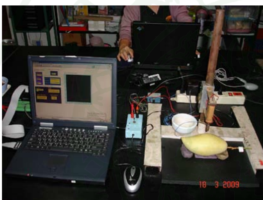
ภาพที่ 5 การวัดหาความแน่นเนื้อโดยใช้เครื่องวัดแรงกระแทกแบบมวลเบา
