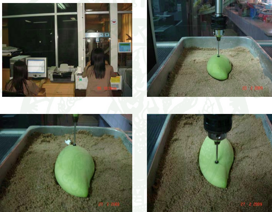
ภาพที่ 6 การวัดหาความแน่นเนื้อเครื่องวัดแรงกด (Universal Testing Machine Lloyd EZ 20)
