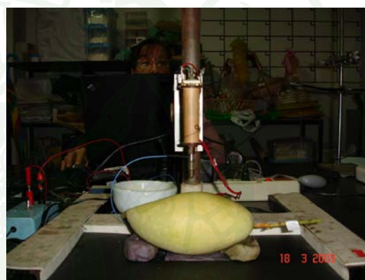
ภาพที่ 5 การวัดหาความแน่นเนื้อโดยใช้เครื่องวัดแรงกระแทกแบบมวลเบา
