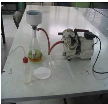
ภาพผนวกที่ ก14 กรองน้ำสีเพื่อแยกปูนขาวด้วยเครื่องดูดสูญญากาศ
