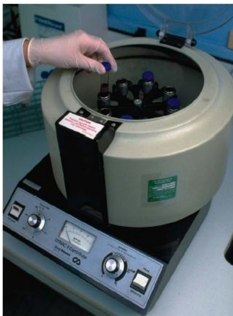
ภาพผนวกที่ ก2 นำสารละลายสีไปแยกปฏิกิริยาด้วยเครื่องหมุนเหวี่ยง
