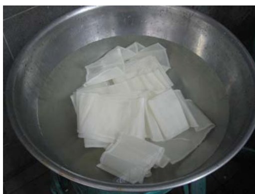
ภาพผนวกที่ ก9 แช่ผ้าไหมสำหรับทอลงในน้ำกลั่น 1 ชั่วโมง
