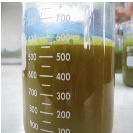
ภาพผนวกที่ ก13 พักน้ำสีเพื่อรอปูนขาวตกตะกอน
