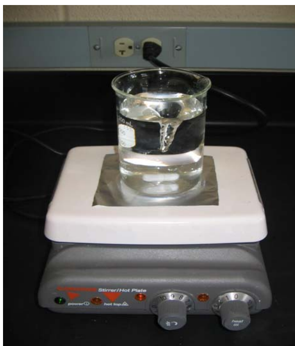
ภาพผนวกที่ ก4 ละลายด่างในน้ำกลั่นด้วยเครื่อง Magnetic stirrer
