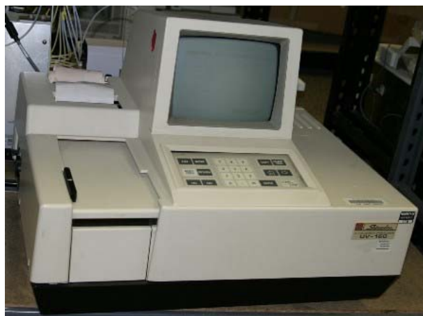
ภาพผนวกที่ ก3 นำน้ำสีครามไปวัดค่าดูดกลืนคลื่นแสงด้วยเครื่อง UV. Vis Spectrophotometer
