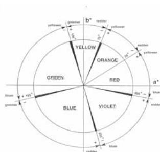
ภาพที่ 13 ความหมายของ dH^* ในระบบ CIELAB ที่มา: ส่วนอุตสาหกรรมสิ่งทอ (2542)
