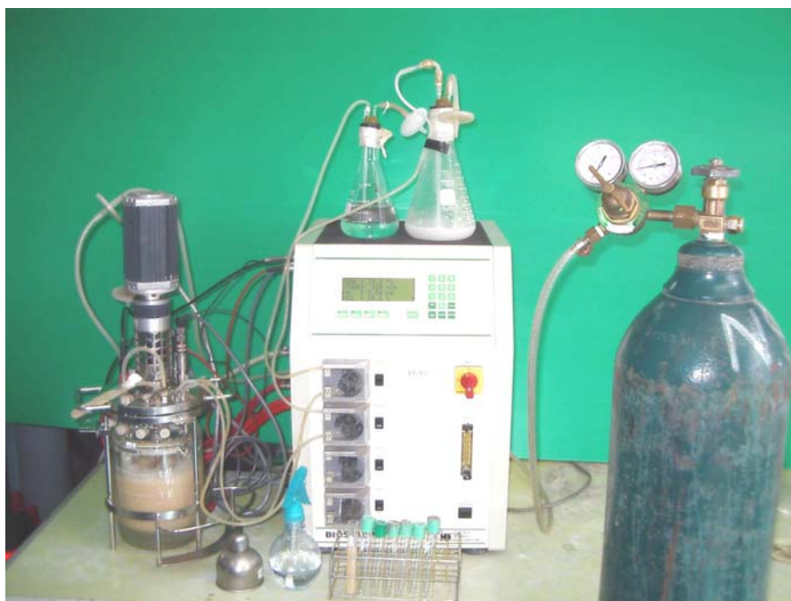
ภาพผนวกที่ ก1 ถังหมัก Biostat B (B. Braun Biotech International) ขนาด working volume สูงสุด 2 ลิตร
