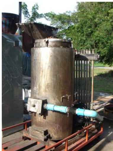
ภาพที่ 7 เตาผลิตก๊าซชีววมวลชนิดไหลลง
