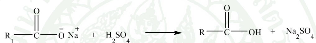
ภาพที่ 18 ปฏิกริยาระหว่างสบู่ในกลีเซอรอลดิบและกรดซัลฟิวริก
