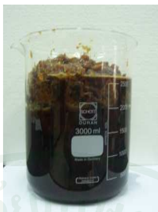
ภาพที่ 17 กลีเซอรอลดิบจากกระบวนการผลิตไบโอดีเซล
