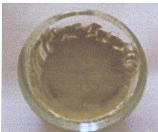
รูปที่ 26 นาโนซิลเวอร์เคลย์สำหรับทำเครื่องประดับด้วยเทคนิคการลอกลาย
