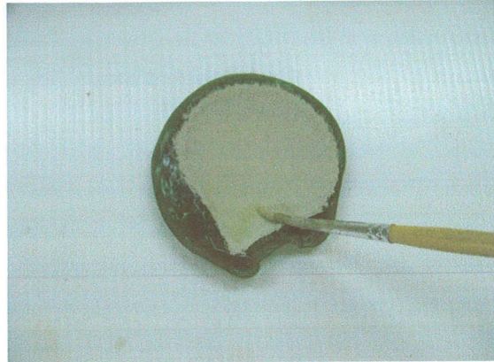
(ข) การทาซิลเวอร์เคลย์เหลวลงบนแม่พิมพ์
