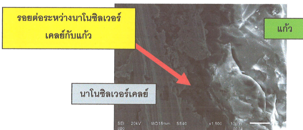
รูปที่ 43 ภาพ SEM บริเวณรอยต่อของแกวสีเขียวกับนาโนซิลเวอร์เคลือบที่บริเวณต่างๆ ที่เผาที่อุณหภูมิ 800°C กำลังขยาย 500X และ 1,000X
