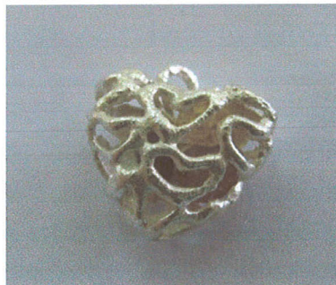
รูปที่ 33 การขึ้นรูปนาโนซิลเวอร์เคลย์แบบเส้นทับรูปทรงกลมเครื่องประดับที่เตรียมไว้ (ในรูป 32) และตัวอย่างหลังเผาและขัดชิ้นงาน
