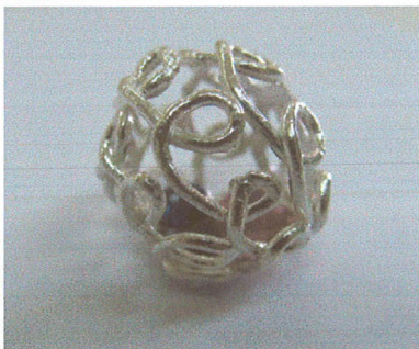
รูปที่ 33 การขึ้นรูปนาโนซิลเวอร์เคลย์แบบเส้นทับรูปทรงกลมเครื่องประดับที่เตรียมไว้ (ในรูป 32) และตัวอย่างหลังเผาและขัดชิ้นงาน
