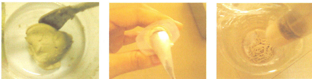
รูปที่ 31 การเตรียมนาโนซิลเวอร์เคลย์โดยการใส่นาโนซิลเวอร์เคลย์ลงในกระบอกฉีดยา
