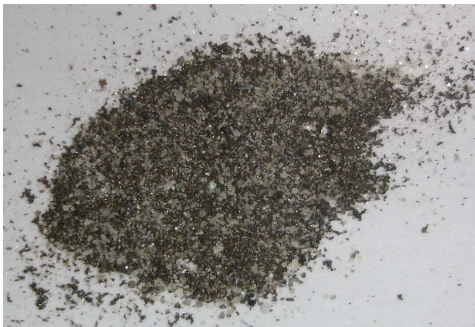
ภาพที่ 4.1 ผงเหล็กที่จับได้โดยแม่เหล็ก
