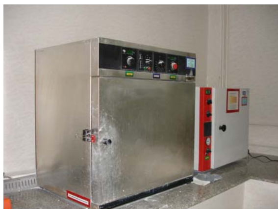
ภาพที่ 3.4 ตู้อบซึ่งใช้ในการอบแห้งแคลเซียมคาร์บอเนต
