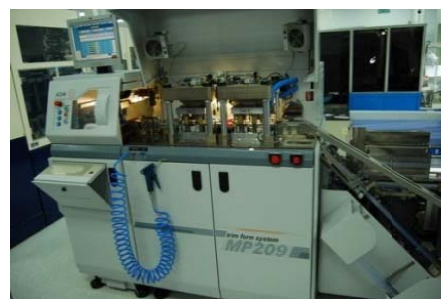
ภาพที่ 4.10 เครื่อง Trim & Form LT#08 เครื่องจักรใช้ขึ้นรูปขางาน
