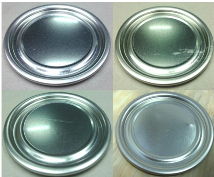
ภาพที่ 3.2 ภาพตัวอย่างลักษณะข้อบกพร่องของผลิตภัณฑ์ที่เกิดจากกระบวนการผลิต
