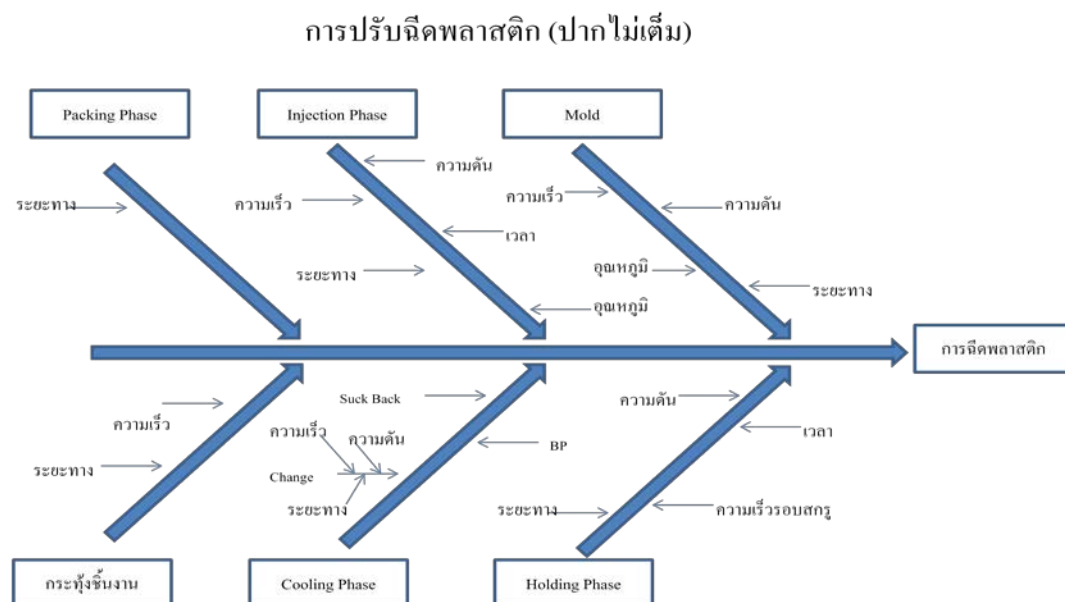
ภาพที่ 4.8 ฟังแสดงเหตุและผล (Cause and effect diagram) แสดงผลการระดมสมองค้นหาสาเหตุปัญหาการปรับฉีดพลาสติก (ปากไม่เต็ม)
