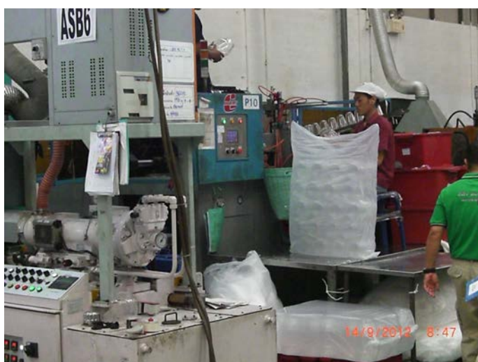
ภาพที่ 3.6 บริเวณกระบวนการเป่าขวดขึ้นรูป
