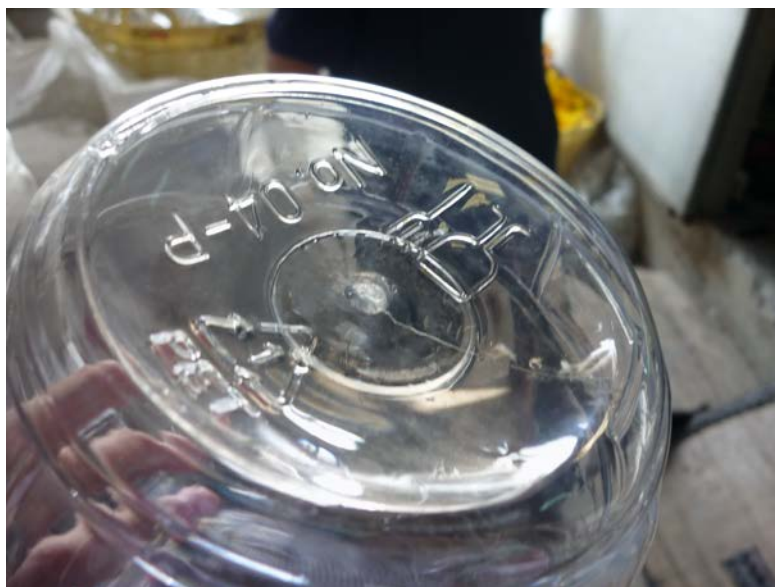
ภาพที่ 3.22 แสดงถึงลักษณะข้อบกพร่อง มีการร้าวเกิดขึ้น
