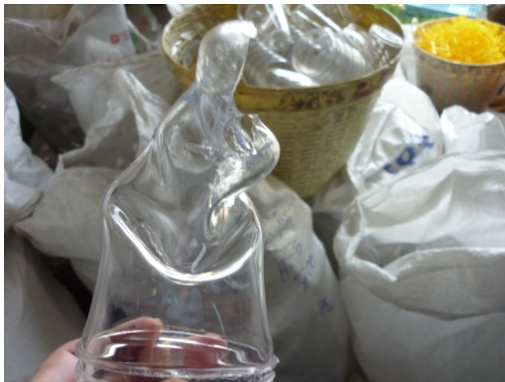
ภาพที่ 3.20 แสดงถึงลักษณะข้อบกพร่อง ชิ้นงานไม่เต็ม
