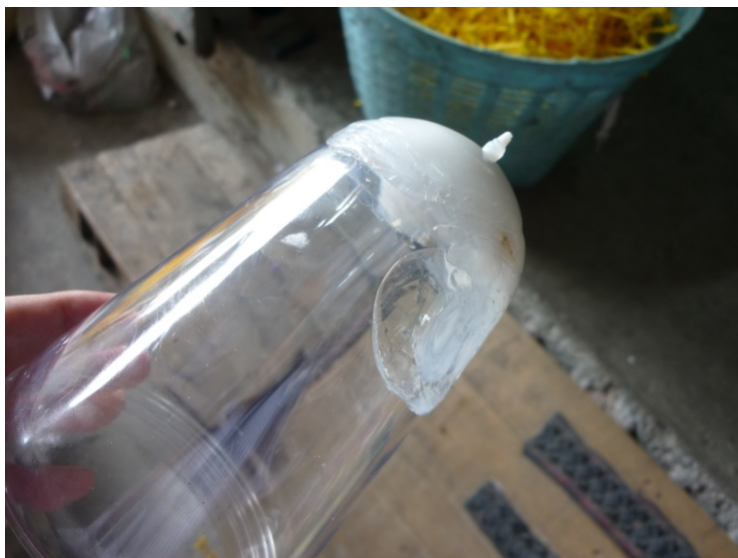
ภาพที่ 3.21 แสดงถึงลักษณะข้อบกพร่อง มีฟองอากาศเกิดขึ้น
