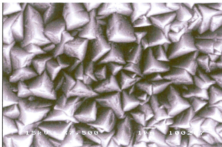
รูปที่ 3 ภาพ SEM ของแผ่นเยื่อบางซีโอไลต์ชนิดโซเดียม-เอ บนตัวรองรับอะลูมินา (ด้านหน้า)
