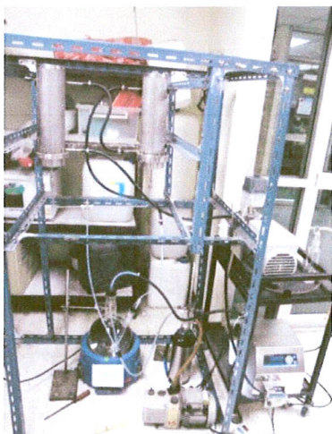
รูปที่ 10 ชุดอุปกรณ์สำหรับกระบวนการแยกด้วยแผ่นเยื่อบางขนาดใหญ่ (large scale pervaporation system)
