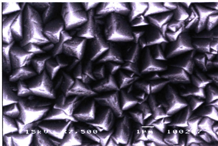
รูปที่ 3 ภาพ SEM ของแผ่นเยื่อบางซีโอไลท์ชนิดโซเดียม-เอ บนตัวรองรับอะลูมินา (ด้านหน้า)
