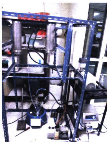
รูปที่ 10 ชุดอุปกรณ์สำหรับกระบวนการแยกด้วยแผ่นเยื่อบางขนาดใหญ่ (large scale pervaporation system)
