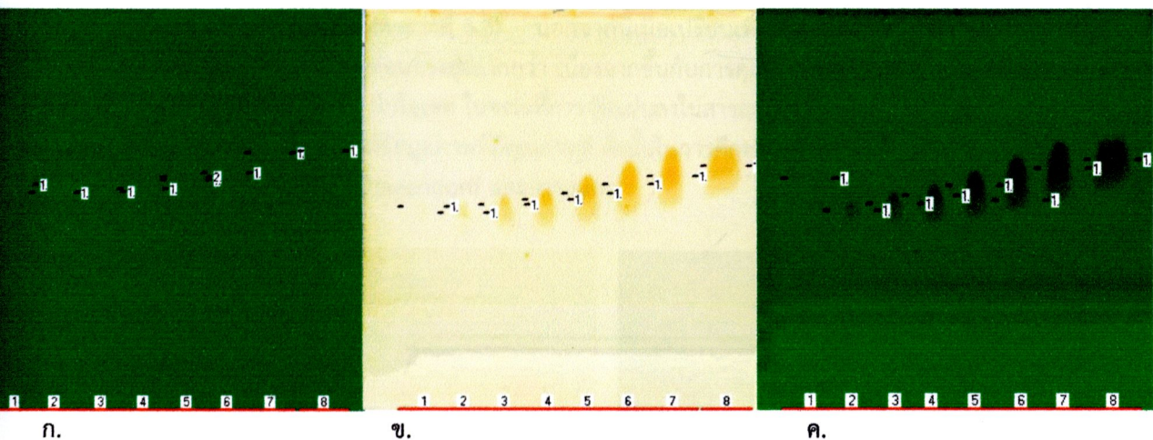
ก. วัสดุภาควัสดุที่ แผ่น TLC ชนิด silica gel 60 F 254 ขนาด 10 x 10 cm วัสดุภาควัสดุที่ toluene-hexane-diethylamine (9:1:0.3)
