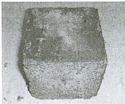
รูปที่ 4.36 ตัวอย่างมอร์ต้าร์ที่แช่ในสารละลายแมกนีเซียมคลอไรด์จนเกิดการยุบ
