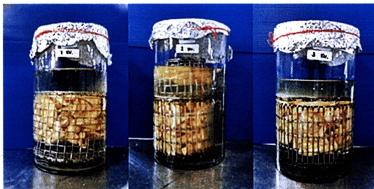
ภาพที่ 3-3 ลักษณะการแช่ขึ้นขนุนในตะกร้าสแตนเลสแบบโปร่ง รูปทรงกระบอกแบบมีฝาปิด ซึ่งมีขนาดรูตะแกรง 2 x 2 เซนติเมตร
