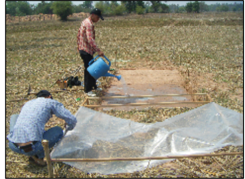
ภาพที่ 3 ไม่มีการเร่งการคายระเหยและขุดคราบเกลือออกแล้วฉีดพ่นน้ำ
